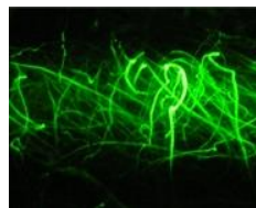
Mesure des vitesses de particules dans un écoulement par vélocimétrie laser
